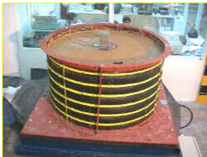
شکل ۱۸- نمایی از آزمایشهای اندرکنش خاک-سازه منفرد
