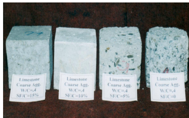
شکل ۱۶- تاثیر درصد میکروسیلیس جایگزین سیمان بر دوام بتن
