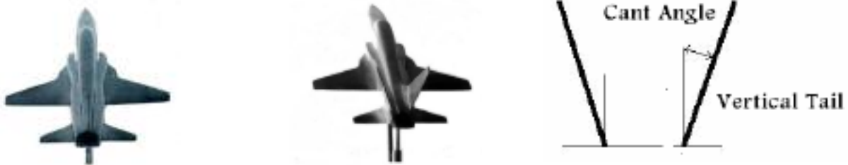
شکل ۲- تصویری از دو مدل استفاده شده به همراه تعریف زاویه کنت
