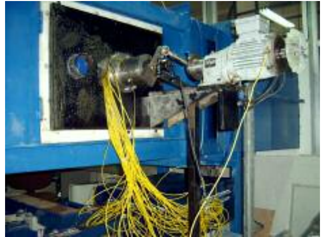
شکل ۴ - سیستم نوسان‌ساز طراحی شده و اینکودر حسگر زاویه حمله
