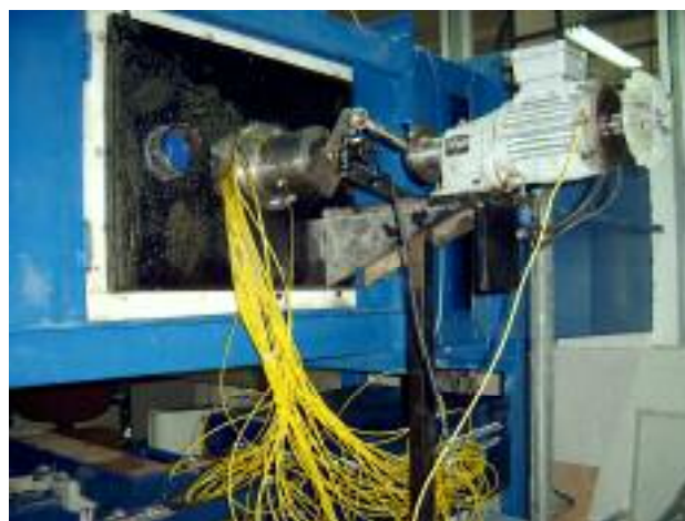
شکل ۴ - سیستم نوسان‌ساز طراحی شده و اینکودر حسگر زاویه حمله
