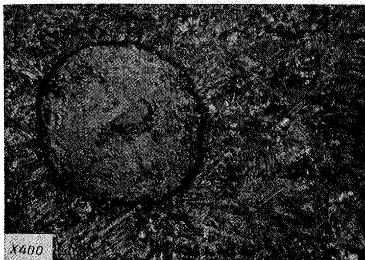
شکل ۷ - تصویر میکروسکوپی نوری از آلیاژ ۳ پس از آستمپر شدن در دمای ۲۸۰ درجه سانتیگراد به مدت ۷۰ دقیقه [ساختار آستنیت باقیمانده (فاز روشن) و فریت بینیتی (فاز تیره)]
