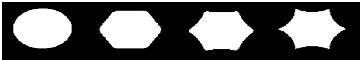
شکل ۳- تأثیر پارامتر m بر انحناى گوشه گشودگی شش ضلعی
