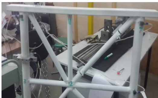
شکل ۹- موقعیت و جایگاه حسگرها روی مدل سکوی دوبعدی
