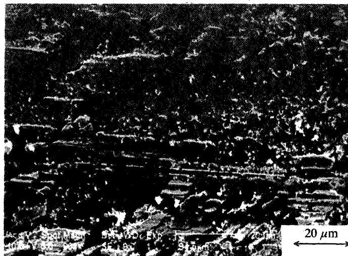
شکل ۸- تصویر میکروسکوپ الکترونی توپوگرافی سطح نمایانگر حفره های ایجاد شده ناشی از ساییش زمینه مارتنزیتی و کنده شدن ذرات کاربیدی
