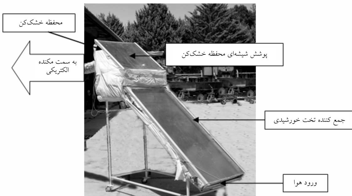
شکل ۱. خشک‌کن خورشیدی مورد استفاده در طرح
