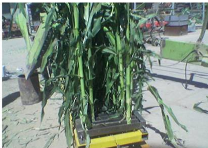
شکل ۶. ریل کالیبراسیون، همان‌طور که در شکل نشان داده شده است دو ردیف ذرت به صورت ایستاده و در شرایطی کاملاً شبیه مزرعه روی ریل قرار گرفته و با سرعتی ثابت وارد دهانه چپر می‌شود.
