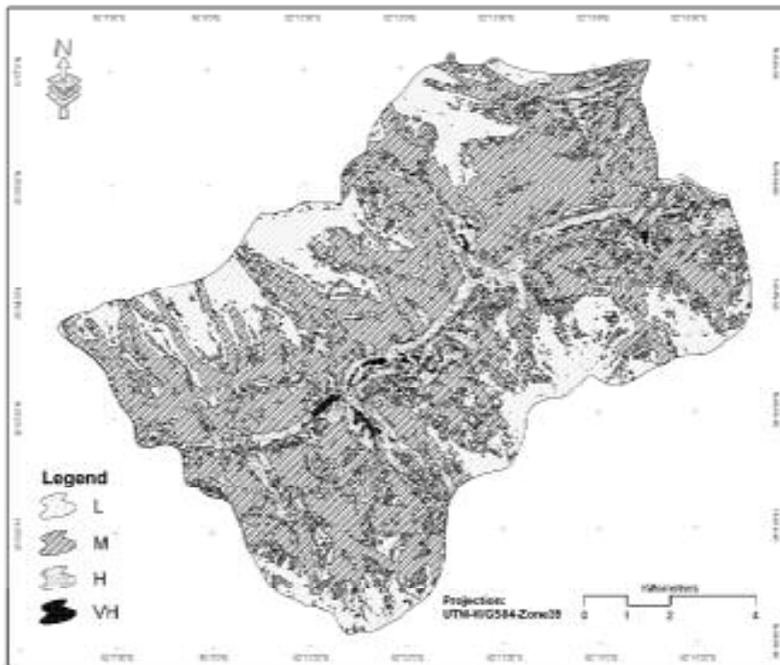
شکل ۹. نقشه خطر لغزش با اپراتور گامای ۰/۹۷۵
