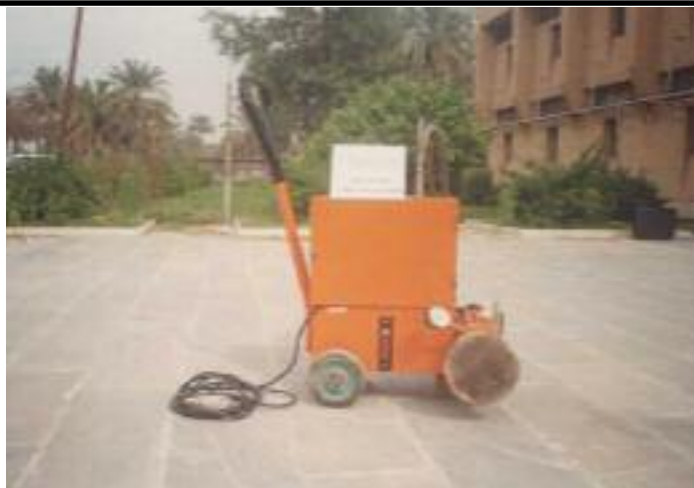
شکل ۴. نمایی از دستگاه مقاومت برشی در محل
