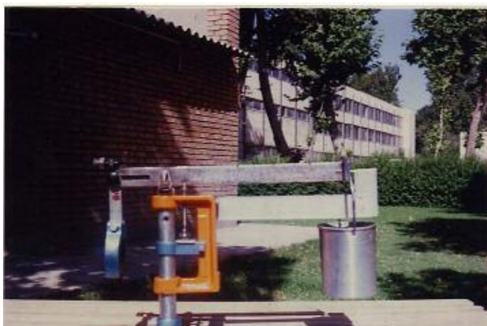
شکل ۱. دستگاه اندازه‌گیری مقاومت کششی
