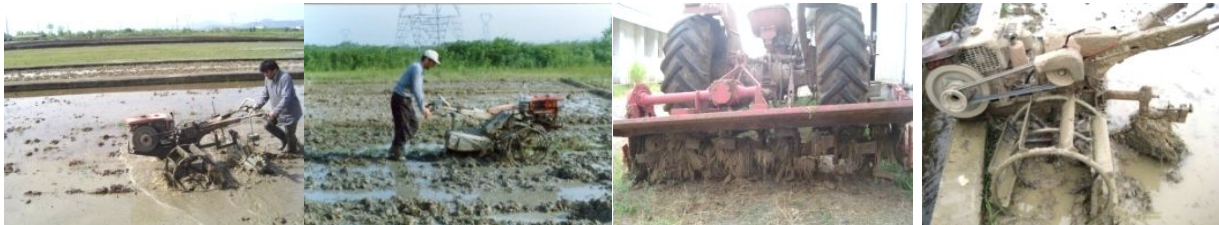
الف) خاک‌همزن مرسوم تیلری (ب) رتیواتور تراکتوری (ج) خاک‌همزن دوار تیلری (د) پادلر مخروطی تیلری شکل ۱. ادوات مرسوم برای عملیات پادلینگ در شالیزار (الف و ب) و ادوات ساخته شده توسط مؤسسه تحقیقات برنج برای عملیات پادلینگ در شالیزار (ج و د)
