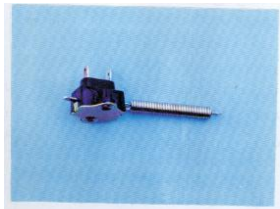
شکل ۳. حسگر وضعیت ترمزها
