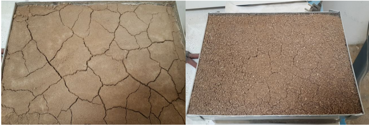
شکل ۸. ترک‌های به وجود آمده در سطح خاک و وقوع پدیده پولکی شدن
