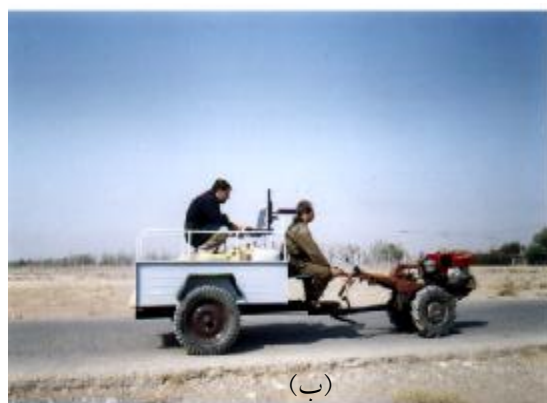
شکل ۱ (الف) ابعاد ناحیه اندازه‌گیری صدا (ب) تراکتور دوچرخ و تجهیزات اندازه‌گیری صدا در موقعیت گوش راننده
