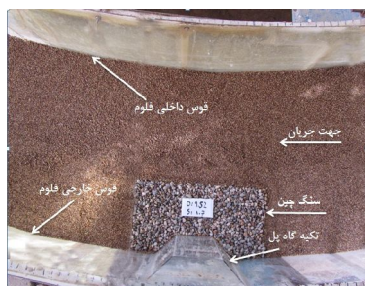
شکل ۳. تکیه گاه و سنگ چین اطراف آن قبل از آزمایش
