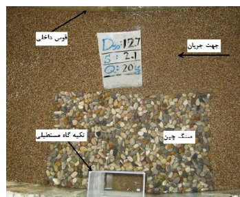
شکل ۳. تکیه گاه و سنگ چین اطراف آن قبل از آزمایش
