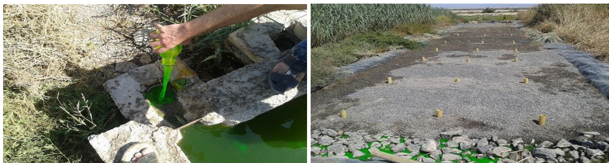
شکل ۳. تزریق محلول رنگ اورانین در لحظه ورود جریان به تالاب
