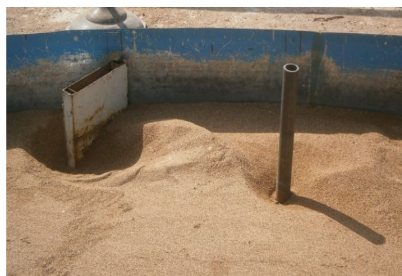
شکل ۷. پایه پل و آبشکن دافع در دبی ۴۹ لیتر بر ثانیه - الگوی آبستگي در اطراف پایه و آبشکن
