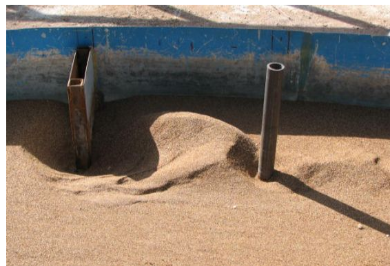
شکل ۶. پایه پل و آبشکن عمودی در دبی ۴۷ لیتر بر ثانیه - الگوی آبستگي در اطراف پایه و آبشکن
