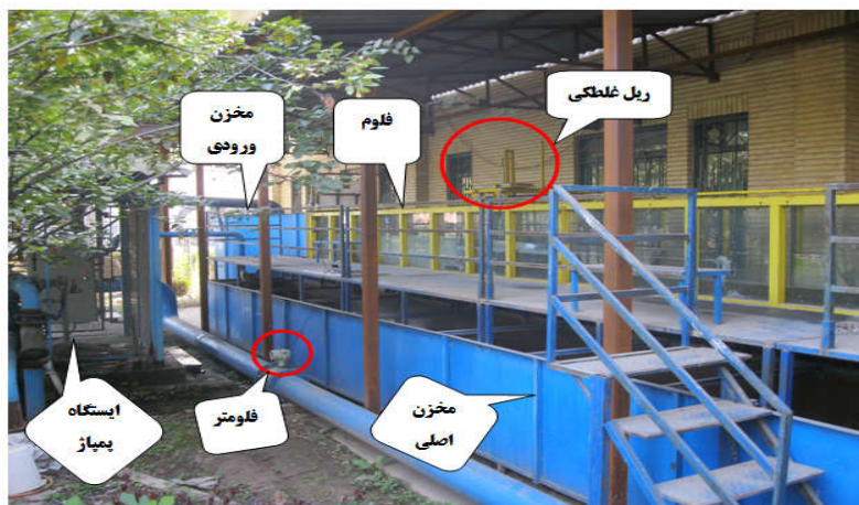
شکل ۴. کانال آزمایشگاهی به همراه تجهیزات آن
