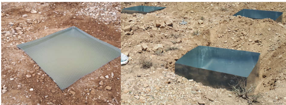
شکل ۳. تشت تبخیر کلرادو مدفون ساخته شده برای انجام آزمایش
