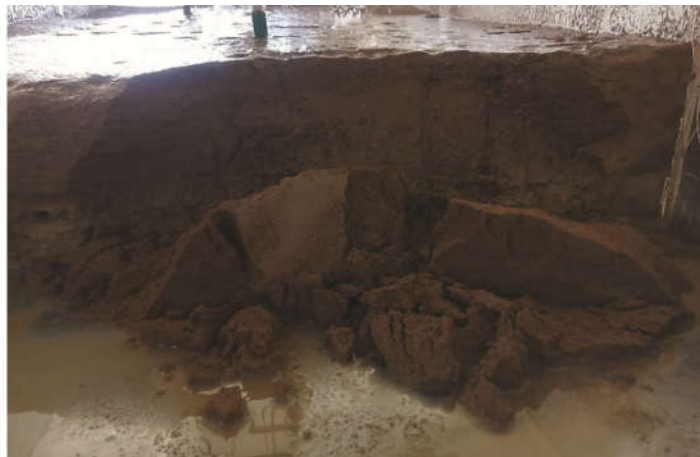
شکل ۶. ریزش در قسمت جلوی خاک در شیب شش درصد
