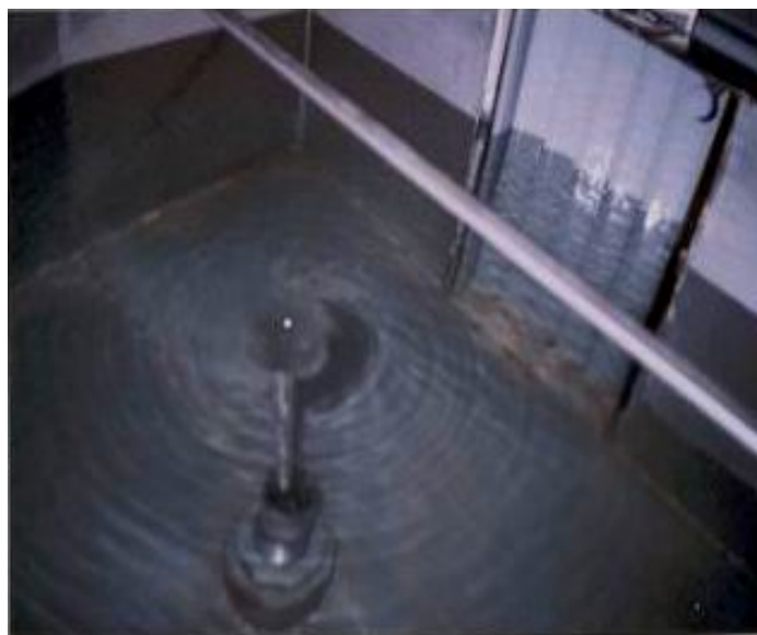
شکل ۸. مدل درحال آزمایش و گرداب تشکیلی
