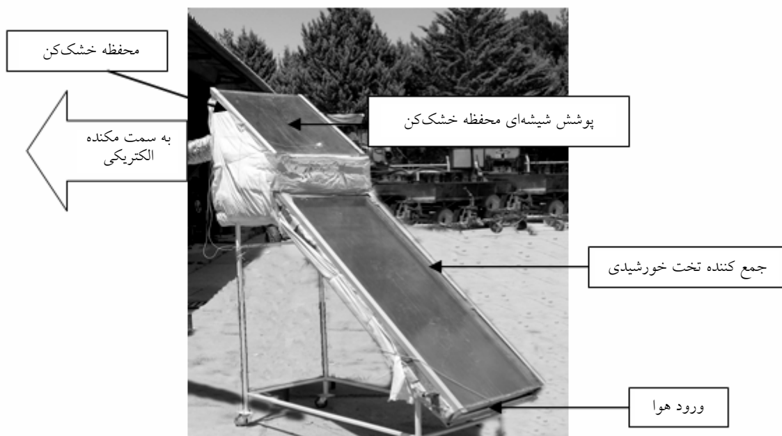
شکل ۱. خشک‌کن خورشیدی مورد استفاده در طرح
