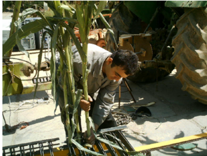
شکل ۷. قرارگیری ذرت‌ها روی ریل کالیبراسیون
