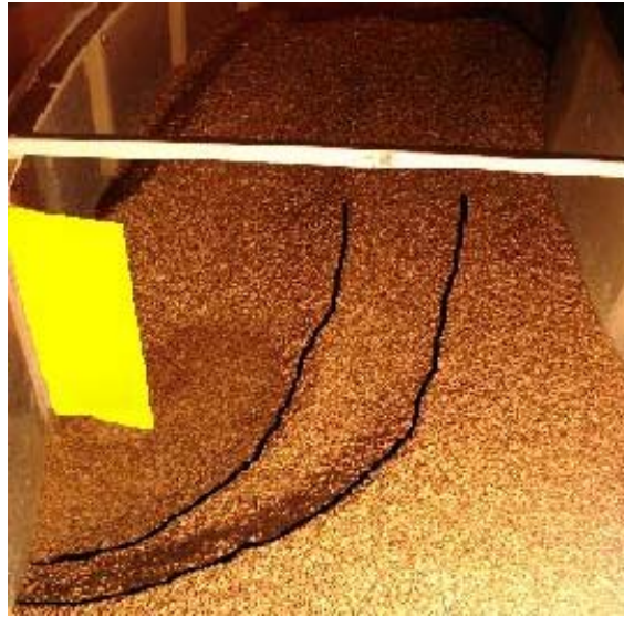
شکل ۳. فروافتادگی و رسوب‌گذاری در پایین دست آبشکن به دلیل انحراف جریان
