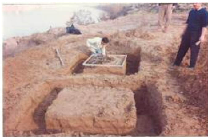
شکل ۵. بلوک‌های آماده آزمایش
