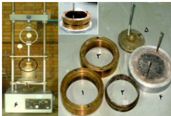
شکل ۱. قالب تراکم مورد استفاده جهت ساخت نمونه‌ها
