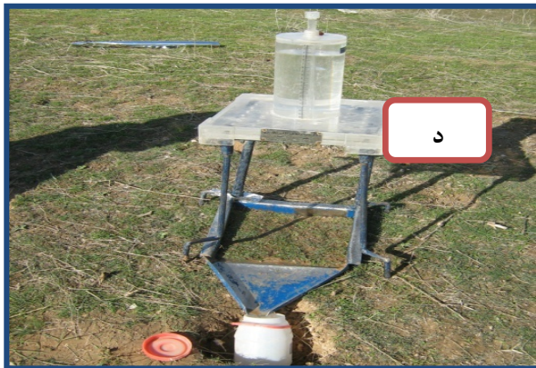
شکل ۱. مراحل مختلف نمونه برداری: شناسایی محل نصب پلات (الف)، مستقر نمودن پلات (ب)، نصب باران ساز بر روی پلات (ج) و انجام نمونه برداری و برداشت روان آب و رسوب (د).
