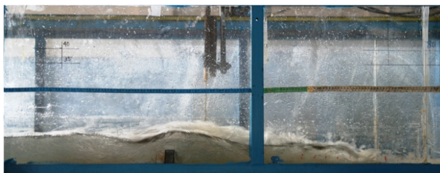
شکل ۴. پرش تثبیت شده توسط آبیایه انتهایی با مقطع کم عرض مستطیلی ( L_B = 110\text{cm} و h = 6\text{cm} ، Fr_1 = 4/76 ، Q = 35\text{LPS} )
