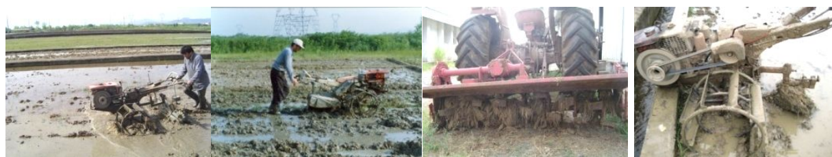
الف) خاک‌همزن مرسوم تیلری (ب) رتیواتور تراکتوری (ج) خاک‌همزن دوار تیلری (د) پادلر مخروطی تیلری شکل ۱. ادوات مرسوم برای عملیات پادلینگ در شالیزار (الف و ب) و ادوات ساخته شده توسط مؤسسه تحقیقات برنج برای عملیات پادلینگ در شالیزار (ج و د)
