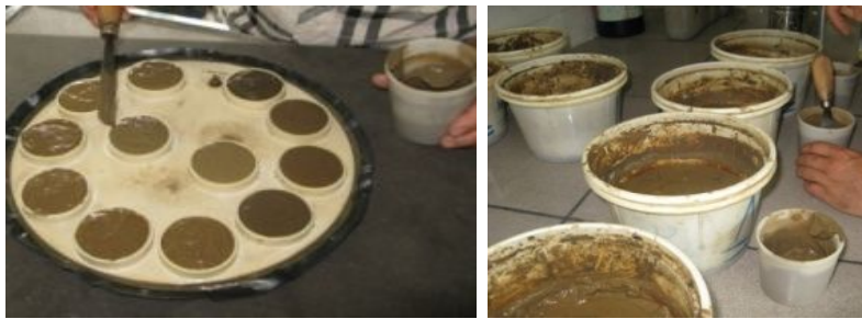
الف) تهیه گل اشباع برای صفحات فشاری ۰/۳ و ۱ بار
