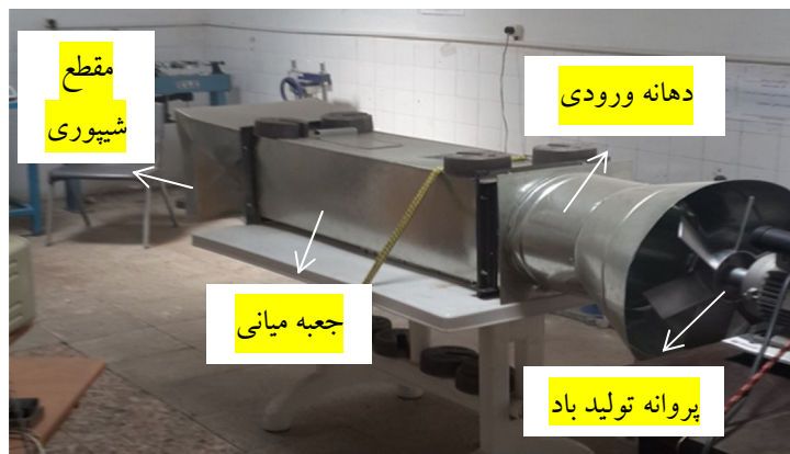
شکل ۱. بخش‌های مختلف دستگاه تونل باد ساخته شده
