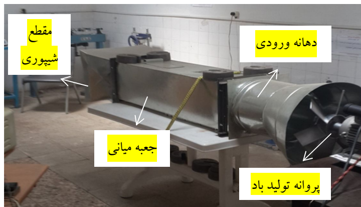
شکل ۱. بخش‌های مختلف دستگاه تونل باد ساخته شده
