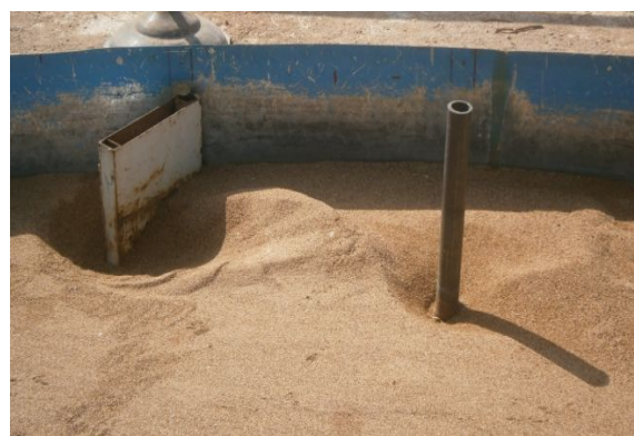
شکل ۷. پایه پل و آبشکن دافع در دبی ۴۹ لیتر بر ثانیه - الگوی آبستگی در اطراف پایه و آبشکن
