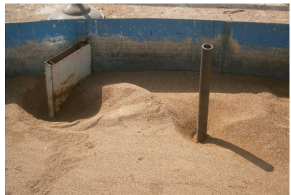
شکل ۷. پایه پل و آبشکن دافع در دبی ۴۹ لیتر بر ثانیه - الگوی آبستگی در اطراف پایه و آبشکن
