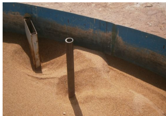
شکل ۸. پایه پل و آبشکن جاذب در دبی ۵۱ لیتر بر ثانیه - الگوی آبستگي در اطراف پایه و آبشکن
