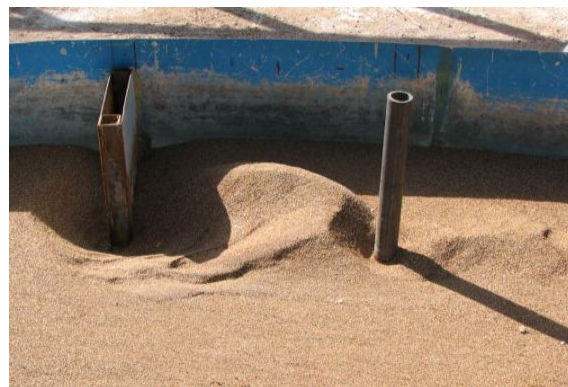
شکل ۶. پایه پل و آبشکن عمودی در دبی ۴۷ لیتر بر ثانیه - الگوی آبستگی در اطراف پایه و آبشکن
