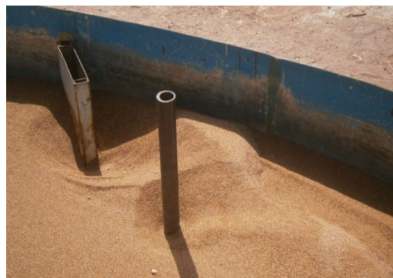
شکل ۸. پایه پل و آبشکن جاذب در دبی ۵۱ لیتر بر ثانیه - الگوی آبستگی در اطراف پایه و آبشکن
