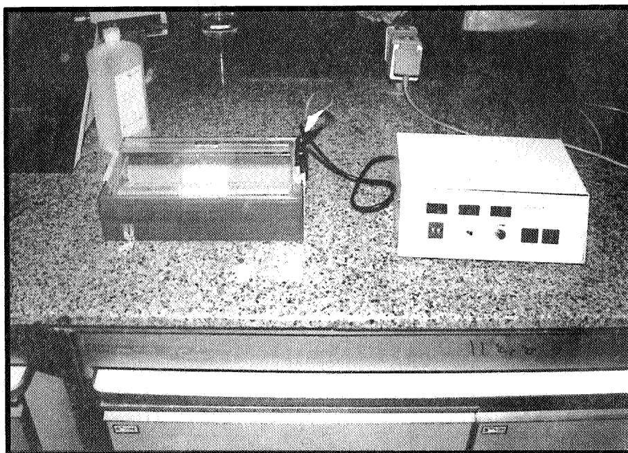
شکل ۱ - دستگاه الکتروفورز افقی و استات سلولز برای انجام آزمایشهای بیوشیمیایی
