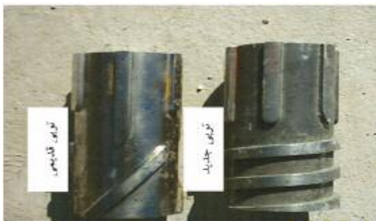
شکل ۴. مقایسه شکل ظاهری قسمت انتقال دهنده برنج در طرح جدید و قدیمی
