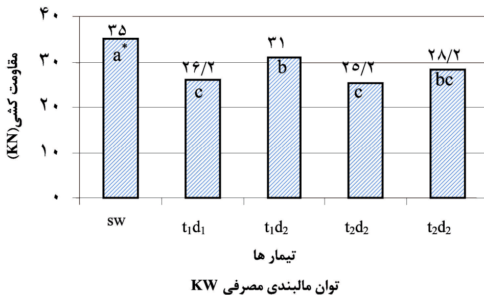
شکل ۲. نمودار مقایسه میانگین مقاومت کشی برای تیمارهای مختلف
