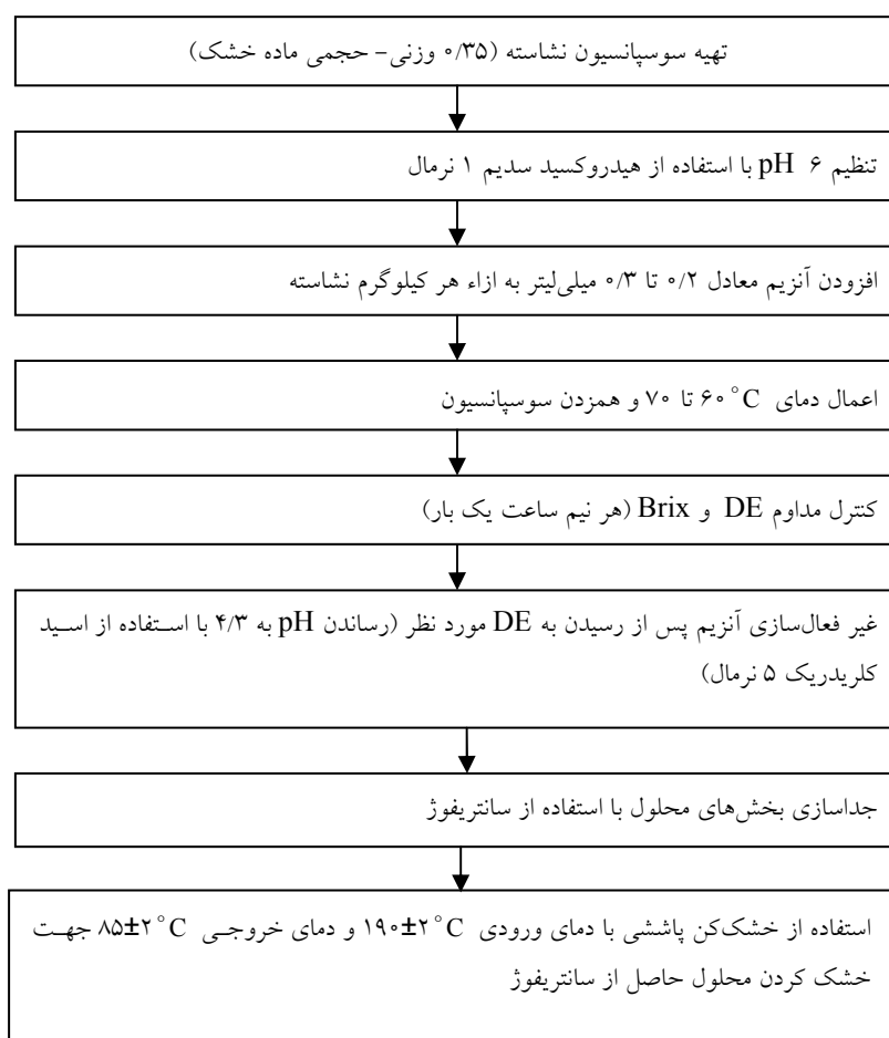
شکل ۱. نمودار فرایند هیدرولیز به کار گرفته شده جهت تولید مالتودکسترین با استفاده از آنزیم آلفا آمیلاز Termamyl 2-x
