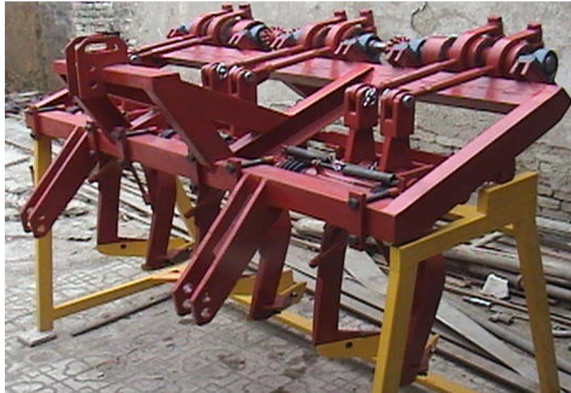
شکل ۱. چغندرکن ارتعاشی مورد آزمایش بدون واحد کنارزن برگ و ردیف کن (نمونه مشابه اونزین).
