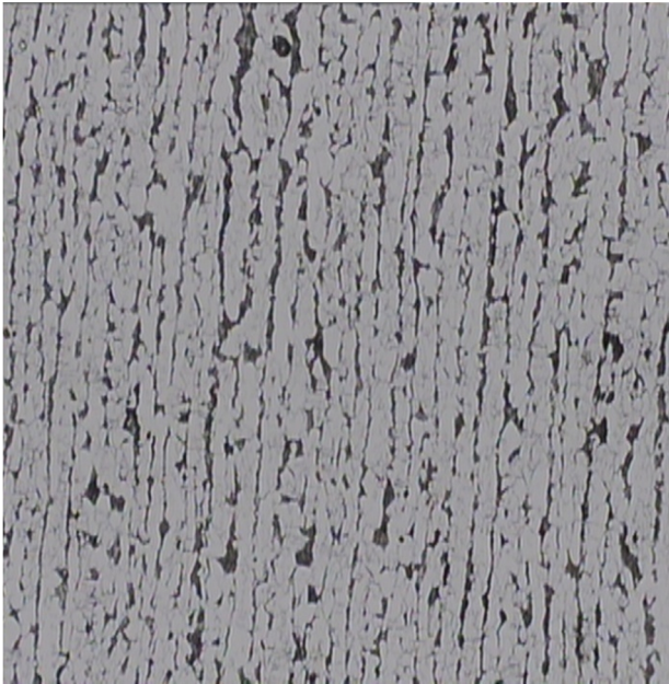
شکل 4- ریزساختار میکروسکوپ نوری فلز پایه (فولاد لوله) که شامل لایه های فریت و پریت است
