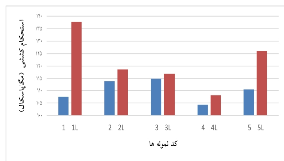
شکل 10- مقایسه استحکام کششی نمونه های جوشکاری شده با و بدون استفاده از لایه میانی به روش اصطکاکی اغتشاشی.
