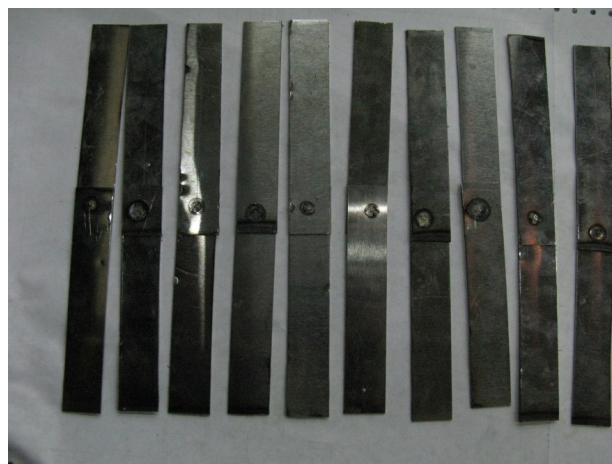
شکل ۲- جوشهای نقطه ای با اندازه دکمه جوش مختلف متناسب با تغییر پارامترهای فرآیند
