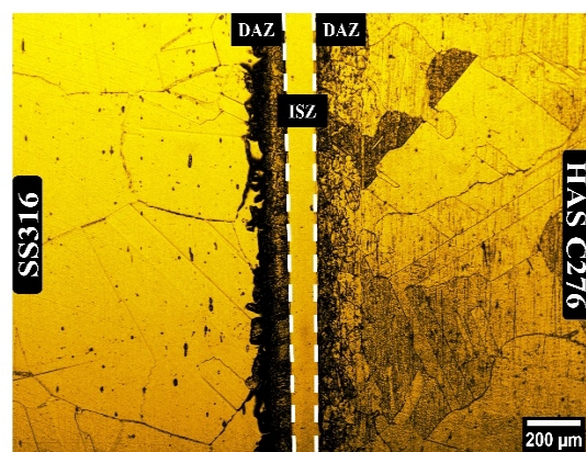
شکل 3- تصویر میکروسکوپ نوری (OM) اتصال انجام شده در دمای 1150 درجه سانتی‌گراد و زمان 5 دقیقه
