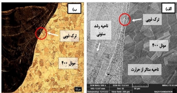
شکل 3 - ریزساختار فلز پایه، منطقه متأثر از حرارت و ترک ذوبی نمونه شماره 5.
