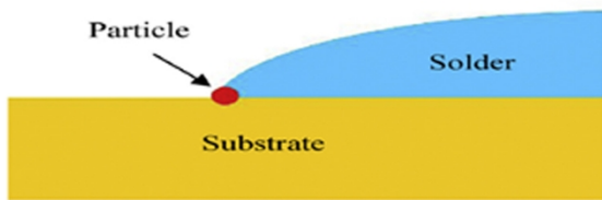
شکل 5- شماتیک محل قرارگرفتن نانو ذرات حین لحیم‌کاری [5].
