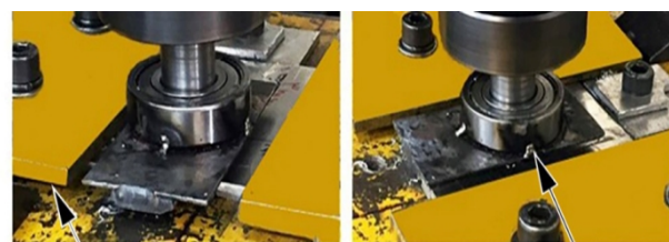
شکل 2- نحوه استفاده از پایه فلزی و نگه‌دارنده جهت جوشکاری نمونه‌ها از زوایای مختلف.
