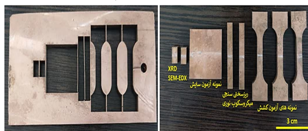
شکل 3- تهیه نمونه‌های استاندارد از کامپوزیت Cu-Ag-SiC
