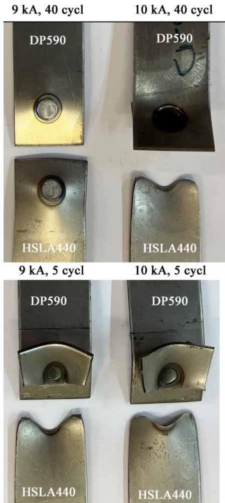
شکل 4- تصاویر شکست نمونه‌ها پس از آزمایش کشش در جریان‌های 9 و 10 و زمان‌های نگه‌داری 5 و 40 سیکل.
