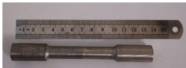
شکل 2- نمونه آماده شده برای انجام آزمایش کشش مطابق استاندارد ASTM E8.
